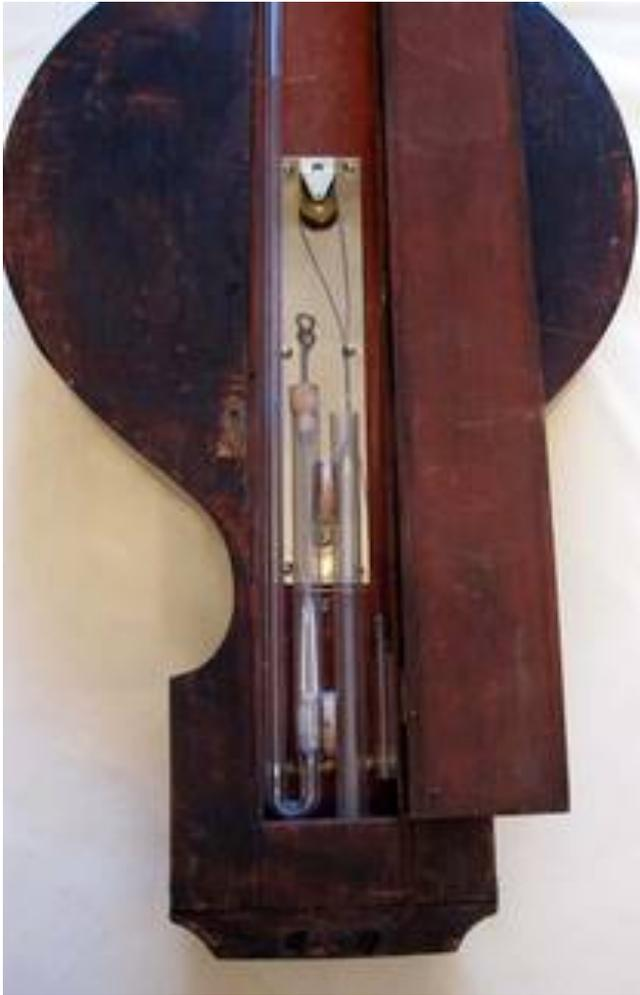
Abbildung 5. Bild: [kleinanzeigen.ebay.de/ anzeigen](http://kleinanzeigen.ebay.de/anzeigen). Die Rückseite des Radbarometers zeigt die Mechanik für die Anzeige des Luftdruckes.
