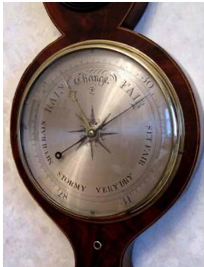
Abbildung 4. Es wird die Frontseite eines Quecksilber Radbarometers gezeigt.
