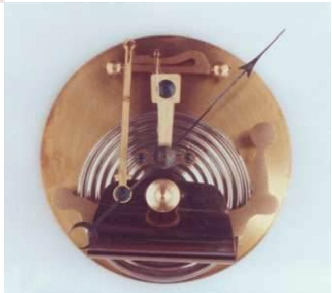
Abbildung 7. Bild: [www.freunde-alterwetterinstrumente.de](http://www.freunde-alterwetterinstrumente.de). In Schwarzmetall ist die Feder sichtbar, welche die Vakuumdose in der Mitte auseinander zieht. Der schwankende Luftdruck verursacht eine Veränderung der Mittendicke der Dose, diese Veränderung wird über eine Mechanik auf den Zeiger übertragen.
