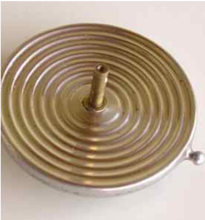
Abbildung 6. Bild: [www.freunde-alterwetterinstrumente.de](http://www.freunde-alterwetterinstrumente.de). Es wird eine Vakuumdose ohne Feder gezeigt. Durch das Vakuum ist die Dose in der Mitte zusammengedrückt. Die Wellenstruktur an der Vorder- und Rückseite bewirkt erstens eine Vergrößerung der Oberfläche, damit wird die Angriffsfläche für den Luftdruck vergrößert und zweitens wird eine Deformation der Dose verhindert.
